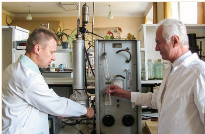
Визначення фракційного складу нафти (проф. О. Б. Гринишин та доц. П. І. Топільницький)
