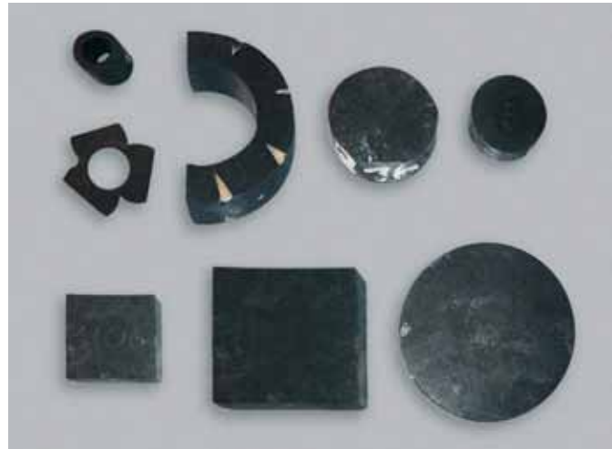
Кераміка на основі \text{MgB}_2 для плавленої текстурованої кераміки на основі \text{YBa}_2\text{Cu}_3\text{O}_7 - (ТТ-YBCO). Ceramics based on \text{MgB}_2 for melt-texturing ceramics based on \text{YBa}_2\text{Cu}_3\text{O}_7 - (ТТ-YBCO).
