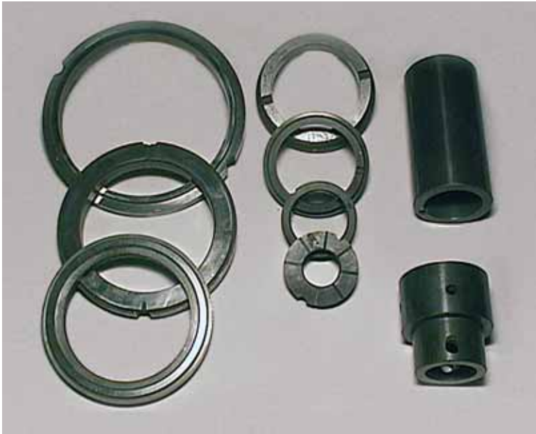
Керамічні кільця, втулки й кулі для торцевих ушлінювачів валів насосів та компресорів і підшипників ковзання з реакційно-спеченого карбїду кремнію. Ceramic rings, bushings and balloons for butt shafts compactor, pumps and compressors and bearings' slide made of reactionary-burned silicon carbide.
