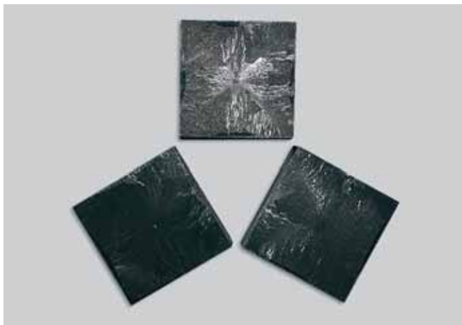
Кераміка на основі \text{MgB}_2 для плавленої текстурованої кераміки на основі \text{YBa}_2\text{Cu}_3\text{O}_7 - (ТТ-YBCO). Ceramics based on \text{MgB}_2 for melt-texturing ceramics based on \text{YBa}_2\text{Cu}_3\text{O}_7 - (ТТ-YBCO).
