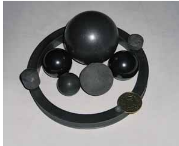
Керамічні кільця, втулки й кулі для торцевих ушлінювачів валів насосів та компресорів і підшипників ковзання з реакційно-спеченого карбїду кремнію. Ceramic rings, bushings and balloons for butt shafts compactor, pumps and compressors and bearings' slide made of reactionary-burned silicon carbide.
