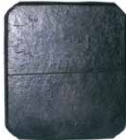
Кераміко-композиційний блок з підпором із кевлара. Ceramic-compositional block with Kevlar shores.
