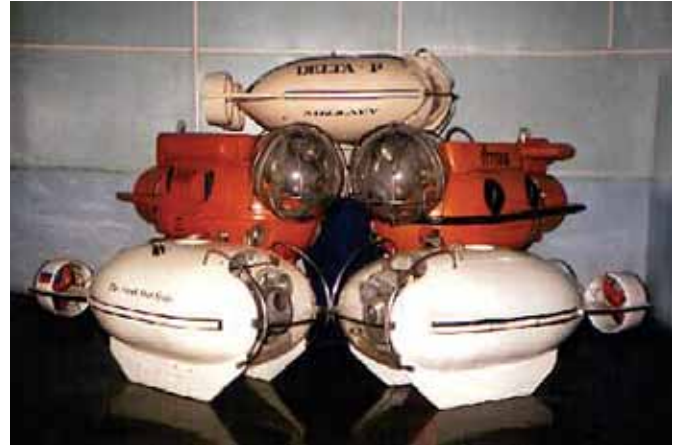
Дистанційно керовані підводні апарати-роботи для дослідження континентального шельфа на глибоководних ділянках (Національний університет кораблебудування імені адмірала Макарова). Remote control submarine robots for examining the continental shelf on deep-water zones (National University of Shipbuilding Named After Admiral Makarov).
