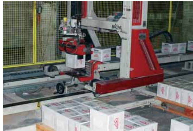
Процес пакування керамічної плити. ТОВ «Карпатська кераміка». Packaging process of ceramic tile. Carpathian Ceramics Ltd.
