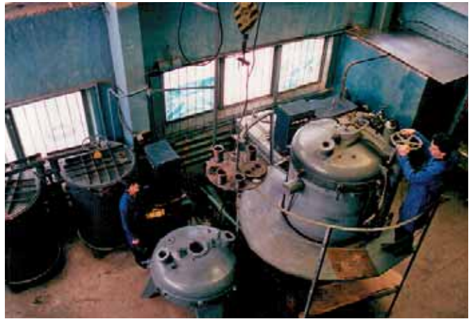
Промислова установка для іонного безводневого азотування, розроблена і виготовлена в ПНФТЦ
